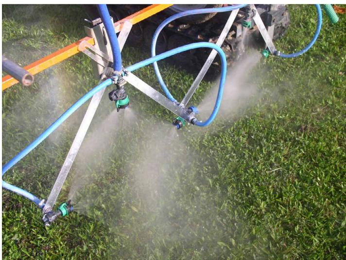
Mit Doppelflachstrahl Düsen ausgestattete Dreidüsengabel
